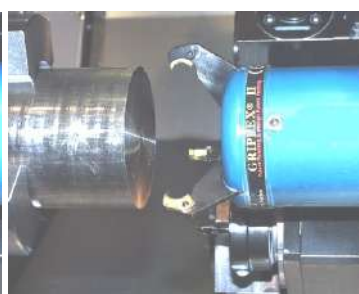
Chiusura mandrino, refrigerante OFF, GRIPPEX rilascia la barra
