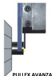
PULLEX AVANZA ALCUNI MILLIMETRI OLTRE IL CENTRO AGGANCIANDO LA BARRA
