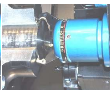
Refrigerante ON GRIPPEX aggancia la barra
