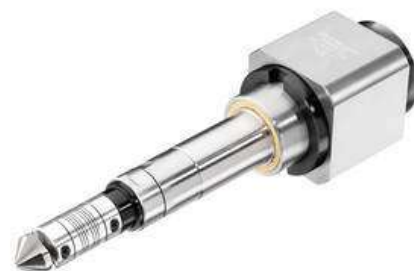
RBS 38-520 AX25 Compensazione giunto: Angolare +/-7° - Asse +/-0.5mm
